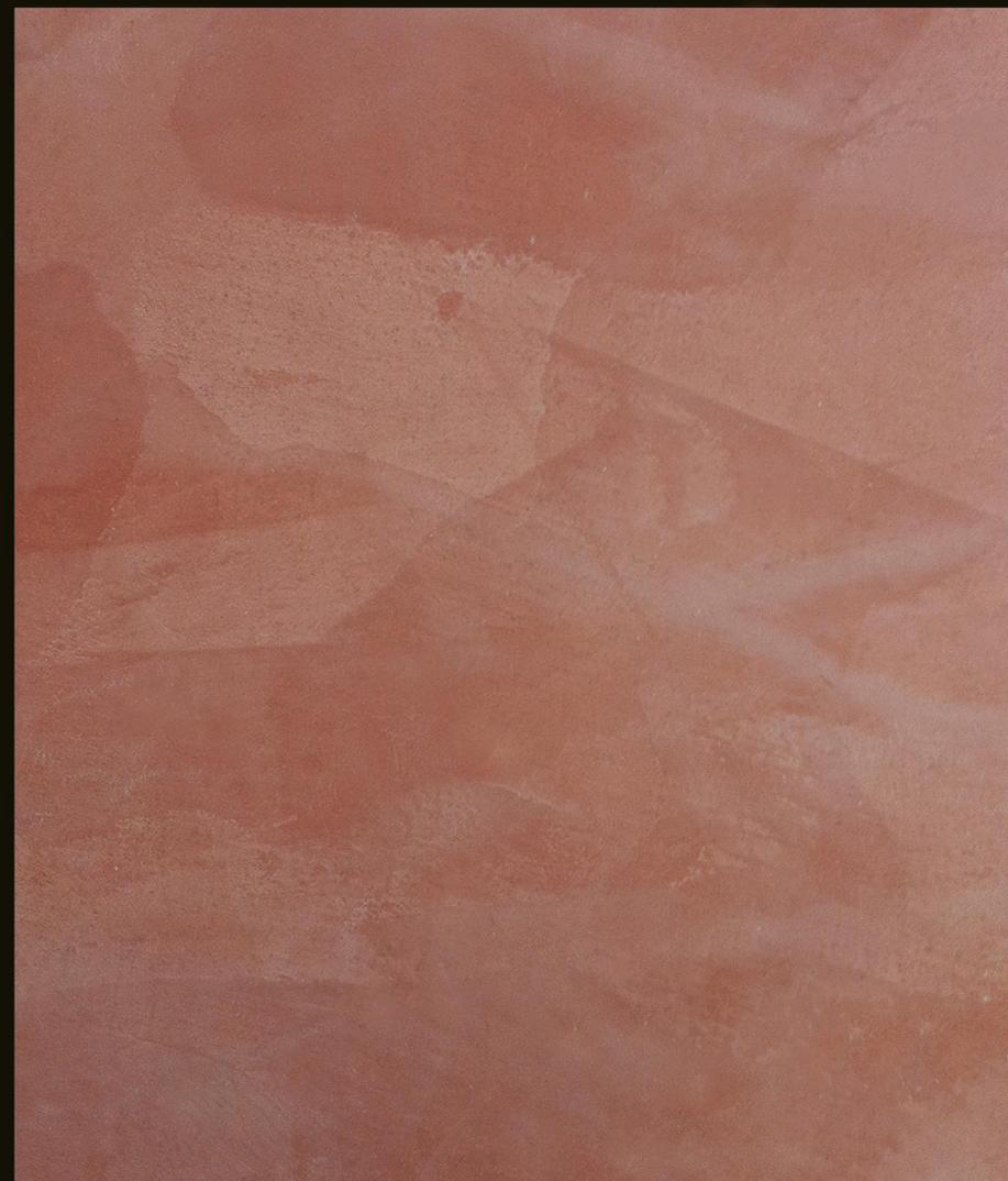
Rivestimento a base di calce idrata invecchiata 12 mesi, e polvere di marmo, formulato con pigmenti inorganici, speciali additivi e cariche minerali inerti. E' resistente ai raggi U.V. ed alle muffe.
